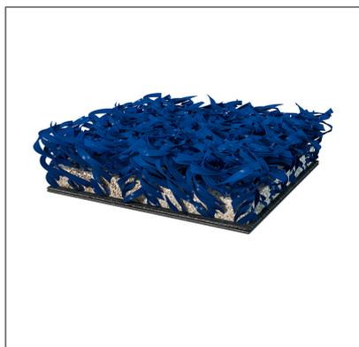
Sistema de césped artificial de última generación, fabricado mediante sistema TUFTING de una medida de galga 3/16" con 28 punt/dm, resultando 58.800 punt/m<sup>2</sup> con filamentos del césped STx Supercourt azul o verde de 10 mm de altura y 9.000 Dtex.
